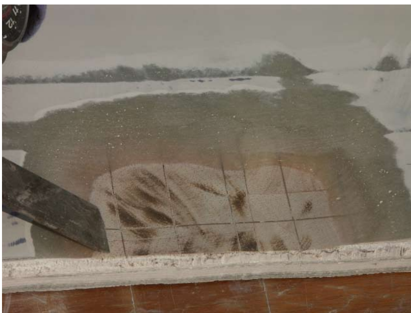
Balsaholz als Sandwich-Kern ist noch heute bei vielen Werften populär, es verfügt über gute mechanische Eigenschaften und Isolationswerte. Problematisch ist die Empfindlichkeit, wenn Feuchtigkeit eindringt.
