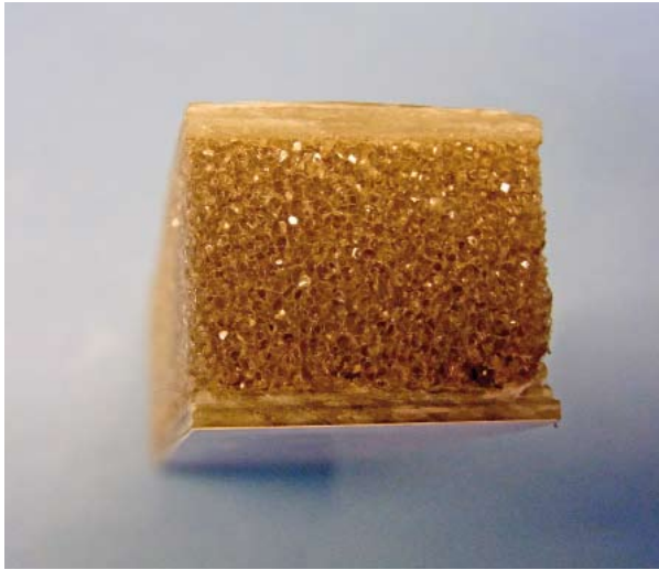
Sandwichkonstruktion mit Schaumkern. Wichtig ist eine gute Klebeanbindung zwischen dem Kern und den Deckschichten.
