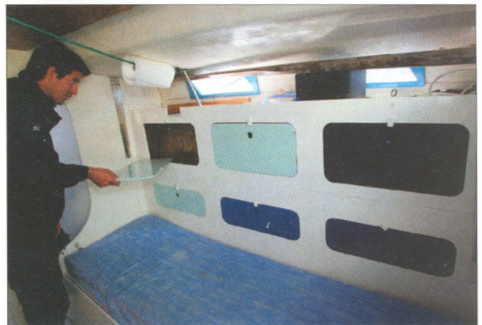
Le volume de rangement dans le carré est exceptionnel, mais les panneaux d'équipets sont montés sans charnière.
