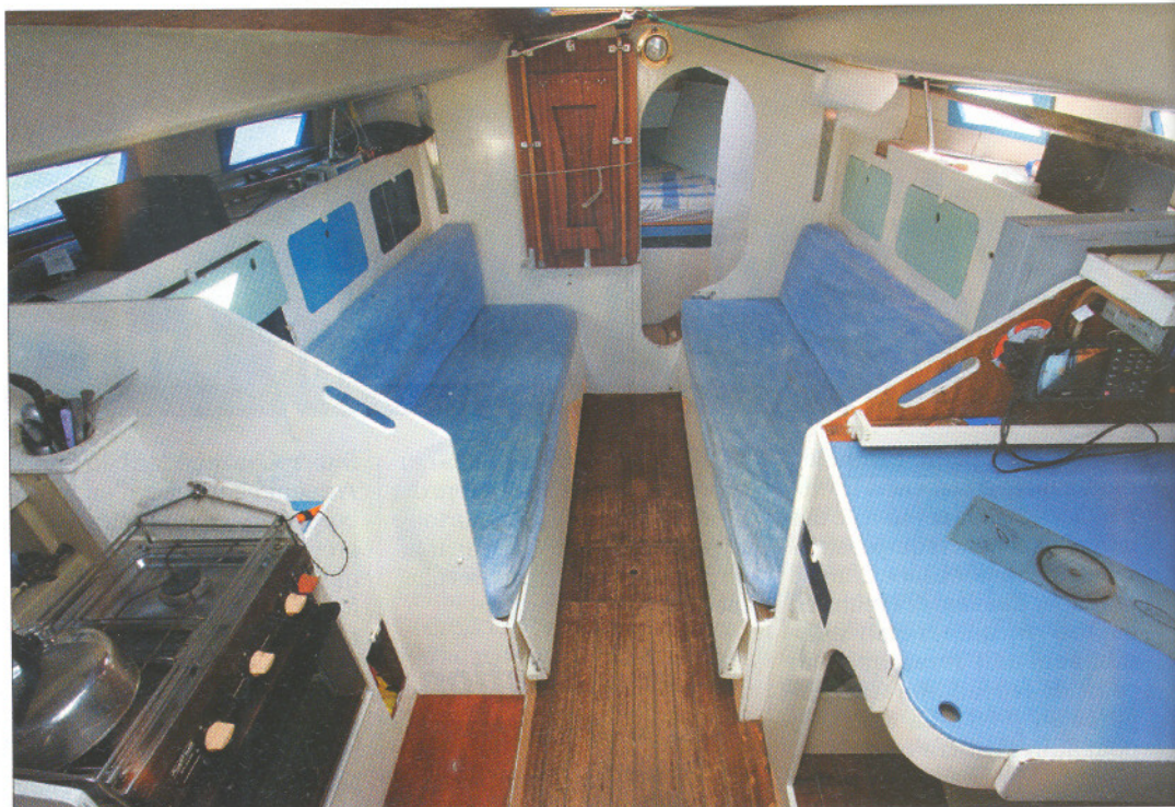
Le carré se distingue par des aménagements « amateurs » très clairs, solides et de bon goût. Les panneaux rabattables au pied des banquettes permettent d'aménager une couchette double.
