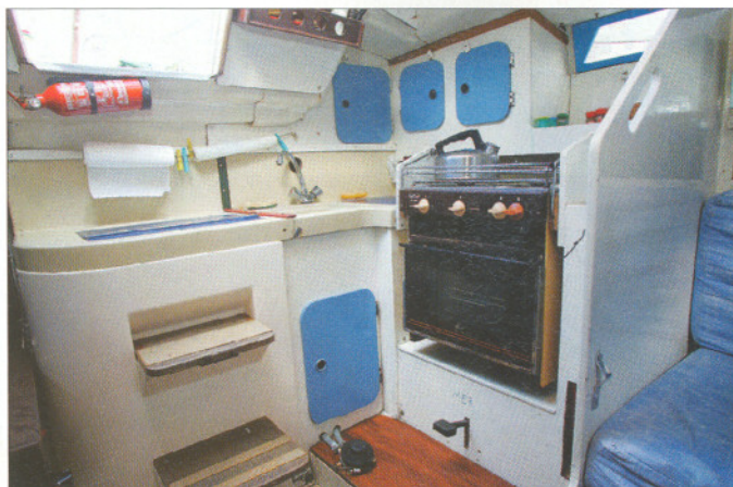
La cuisine - avec four s'il vous plaît - est fonctionnelle, mais il lui manque une sangle pour travailler dos à la gîte.
