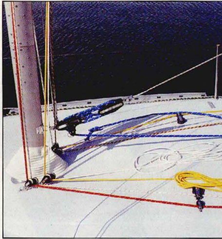
Fallen und Strecker sind nach achtern gelenkt; vom Niedergang aus sind sie vom Vorschoter zu bedienen.
